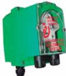
Material: PP. Verde. Material cuerpo bomba : PP color verde - Tubo de conexión: 4 x 6 mm - Material tubo peristáltico : santopreno - Dimensiones: 100 x 80 x 80 mm - Caudal máximo: 5 l/h - Presión máxima: 0,1 bar - Alimentación: 230 Vac - 50/60 Hz - Protección: IP 65 -
