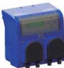
Dimensiones: 177 x 171 x 132 mm - Caudal deterg.: 3-4,5 l/h (1,5 bar) - Caudal abrill.: 1,2-2,1 l/h (2,5 bar) - Alimentación: 230 V -
