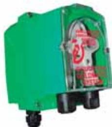
Material: PP. Verde. Material cuerpo bomba : PP color verde - Material tubo peristáltico : silicona - Dimensiones: 100 x 80 x 80 mm - Caudal máximo: 1 l/h - Presión máxima: 4 bar - Tubo de conexión: 4 x 6 mm - Alimentación: 230 Vac - 50/60 Hz - Protección: IP 65 - Regulación mecánica -
